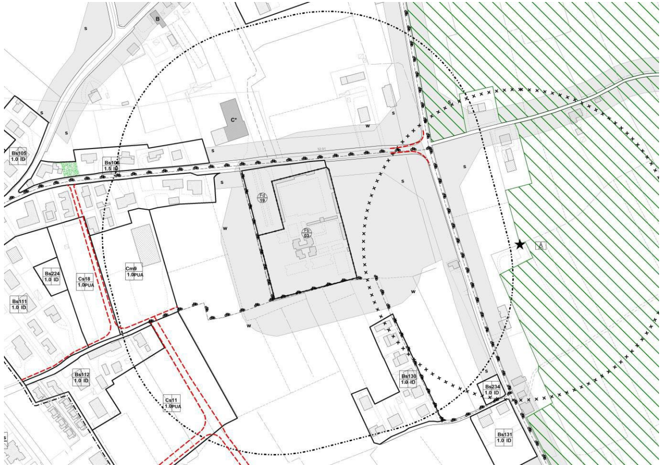
Modifica delle fasce di rispetto cimiteriali di Paderno (in grigio la fascia di rispetto ristretta e con linea tratteggiata quella allargata)
